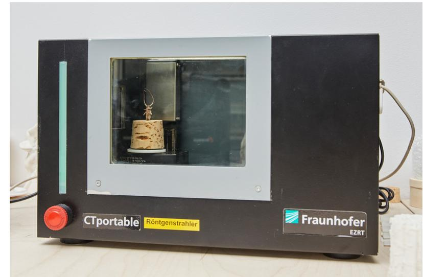
Das CT-Portable unterliegt der Strahlenschutzverordnung und darf nur von geschultem Personal bedient werden.
