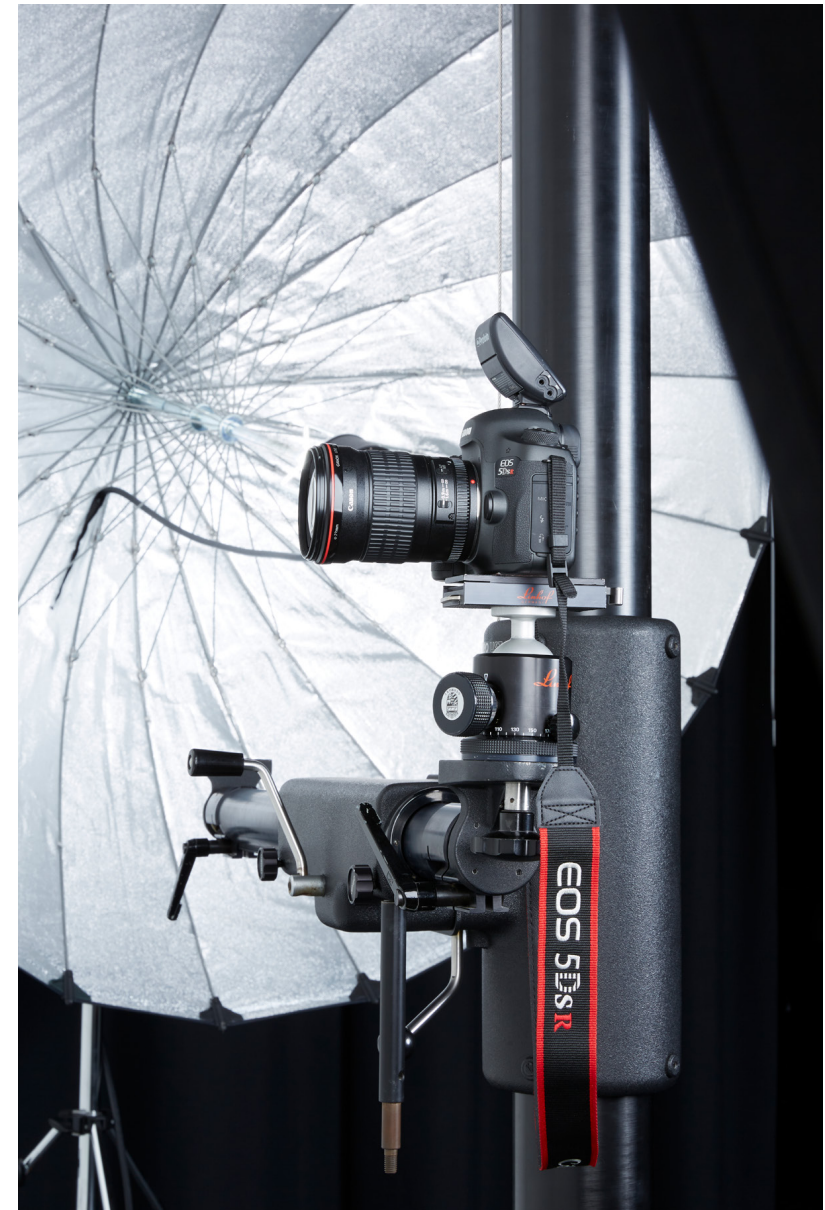
Eine von zwei Studiokameras, ausgestattet mit 50 Millionen Pixeln, angebracht auf einem Studiostativ. Auf der Kamera befindet sich ein Funksender. Im Hintergrund ein Giant-Lichtformer.
